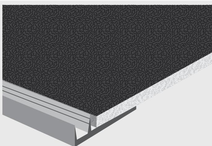
Posizionare la doga del pavimento sopra alla linguetta della base del profilo.
