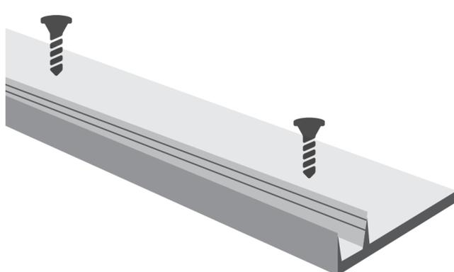
Fissare a terra con viti o colla la base del profilo.
